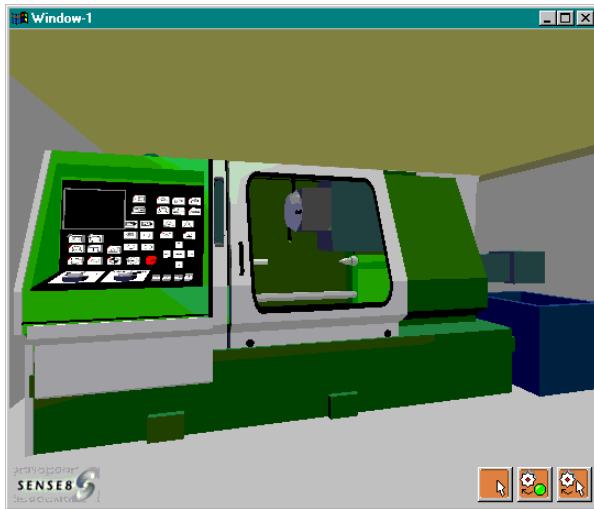
Figura 2: Vista geral do torno CNC com os botões do gerador de falha (canto direito inferior)
